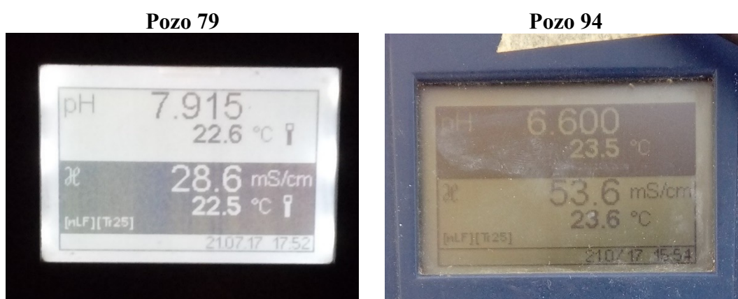
Figura 11. Mediciones de conductividad eléctrica y pH en aguas saladas.
