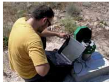
Figura 13. Descarga de datos de oscilación piezométrica en piezómetro equipado a tal efecto. Obsérvese la tapa antivandálica de protección (foto: M. Martínez).
