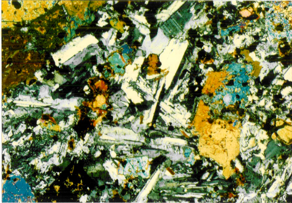
Foto 3 - Olivina sienogabro. Textura tipicamente aliotriomórfica granular. Observam-se cristais de plagioclásio com geminação polissintética e feldspato alcalino, de hábito tabular, geminado segundo a lei de Carlsbad. Além disso, reconhecem-se grãos idiomórficos de augita. Nicóis cruzados, filtro azul, 25X.
