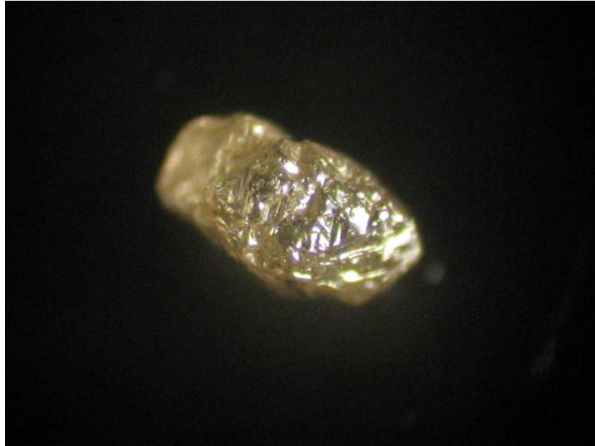
03- Macro-diamante (>1<3 mm) de facas octaedricas inter-penetradas, con bordes suavizados y superficies corroidas. N-Dpto. de San Pedro. 2010
