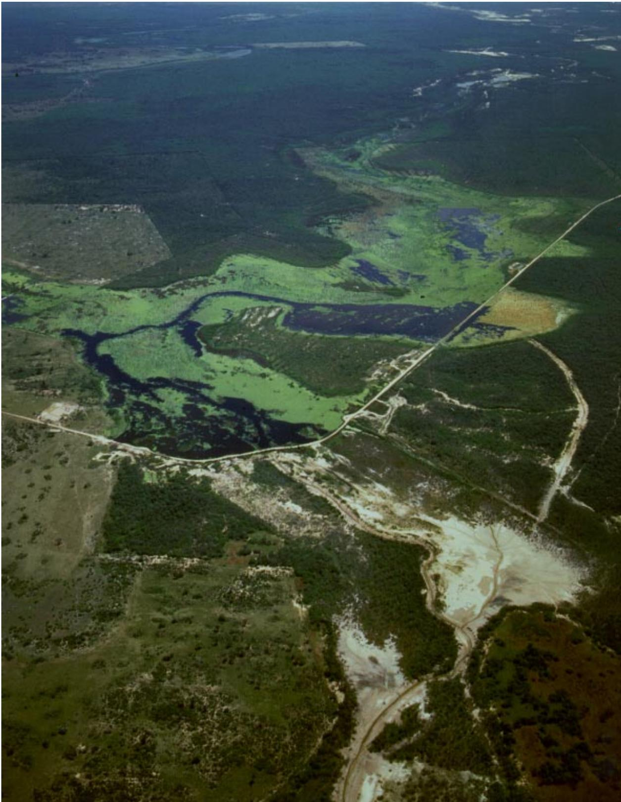
*Fig 59: Embalse del Río Montelindo por la construcción de caminos. Salinización debajo del dique*
