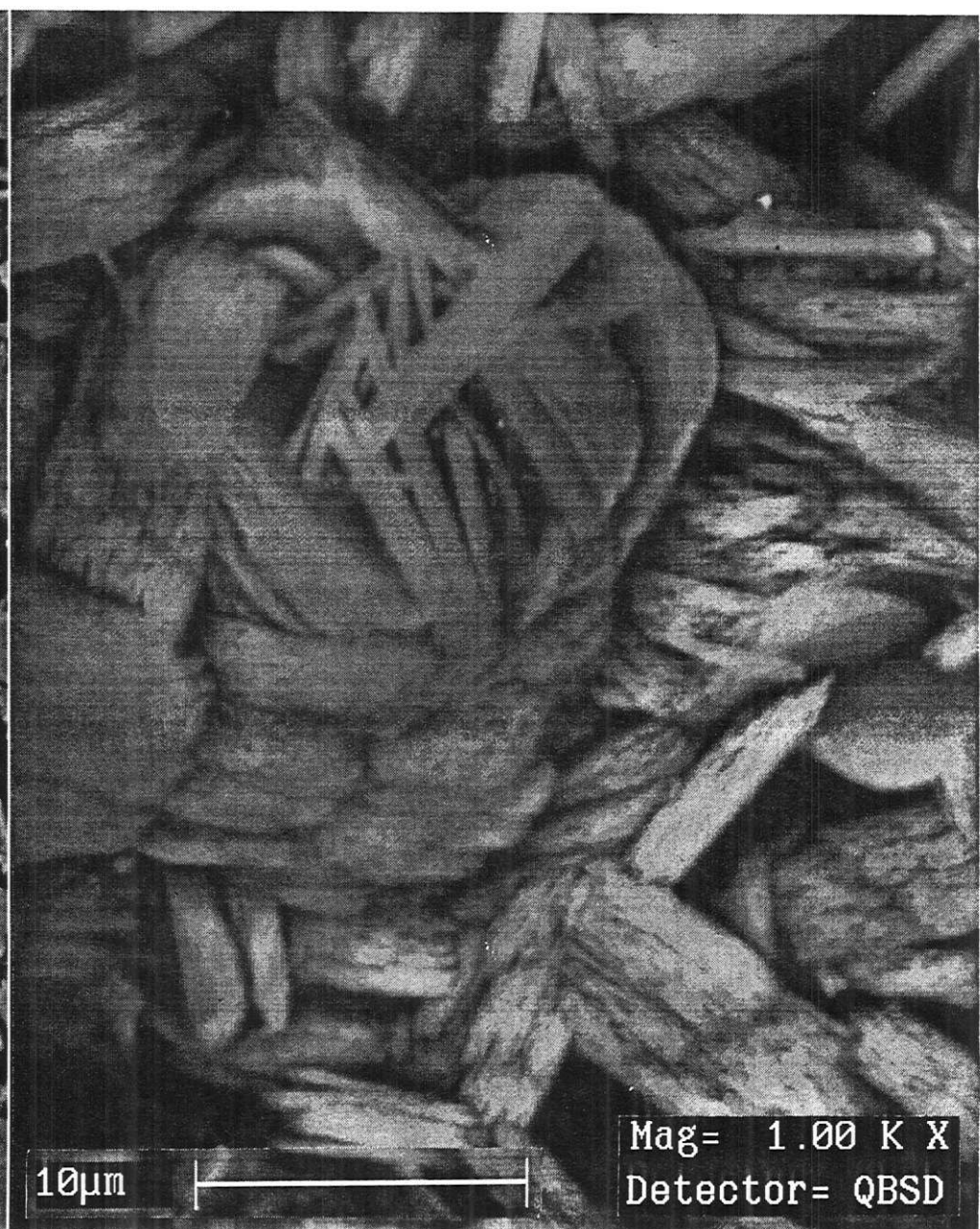
Imagem 42 - Sericita, produto de alteração endógena do feldspato do CCh. Fotos MEV. Amostra C-51.
