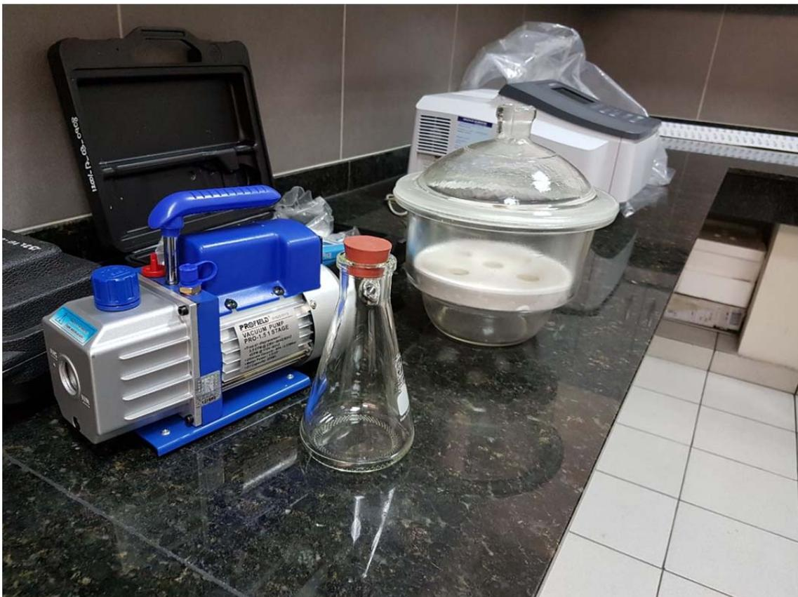
Figura nº05. Bomba de vacío, Kitasato, desecador
