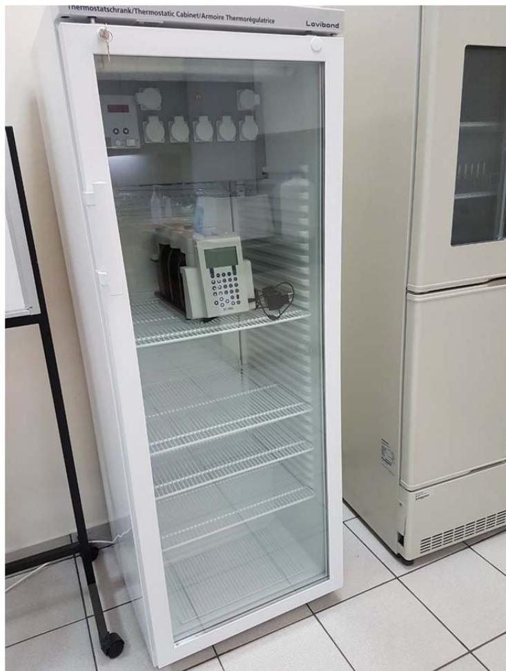
Figura nº02. Incubadora modelo TC256G con el medidor de DBO con 6 sensores modelo TC256 en su interior
